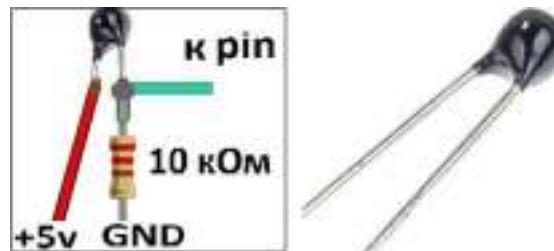
Рис. 3. Схема подключения к микроконтроллерной плате терморезистора
